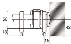
※片壁面の入隅部分に正面付した場合の取付寸法図です。
